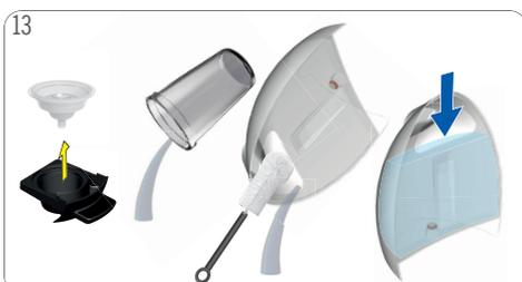
Extraiga el soporte de la cápsula. Retire la herramienta de enjuague. Enjuague el soporte de la cápsula con agua potable fresca por ambos lados. Vuelva a insertar el porta cápsulas. Vacíe y limpie el recipiente. Enjuague y limpie el depósito de agua. A continuación, rellene el depósito de agua con agua potable fresca e insértelo en la máquina.
