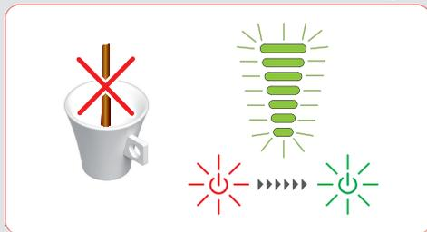
No sale líquido: la preparación de bebida se detiene parcialmente durante la dispensación o no llega a iniciarse. El display de barras parpadea y el botón de encendido parpadea en rojo y verde rápidamente.
