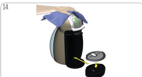
Limpe la máquina con un paño húmedo y suave. Séquela después con un paño seco y suave. Coloque la rejilla de goteo sobre la bandeja de goteo. Luego inserte la bandeja de goteo en la posición deseada.
