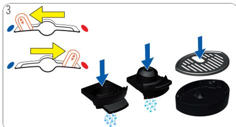
Enjuague la máquina: Siga las instrucciones de 5. on page 1. Limpie con líquido detergente y agua potable fresca ambos lados del soporte de la cápsula. Enjuague la bandeja de goteo con agua potable fresca y límpiela con un cepillo limpio adecuado para alimentos.
