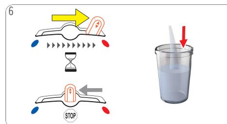
6 Mueva la palanca de selección a la posición "CALIENTE". La máquina se descalcifica en funcionamiento de inicio-alto durante aproximadamente 2 minutos. La bebida salpica en la salida de café.
