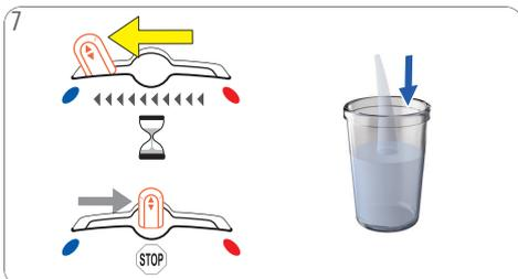
Empuje la palanca de selección a la posición "FRÍA". La máquina se descalcifica continuamente. La bebida salpica en la salida de café.
