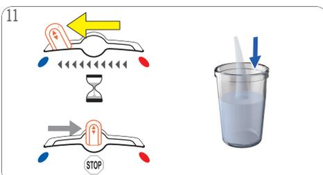
Empuje la palanca de selección a la posición "FRÍA". Espere hasta que la palanca se desplace a la posición "ALTO". La extracción se detiene.
