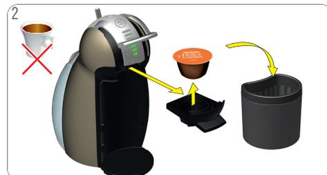
No beba el café. Levante la manija de bloqueo. Retire el soporte de la cápsula. Ponga la cápsula usada en el depósito de cápsulas.
