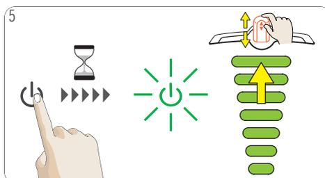
5 Pulse y mantenga pulsado el botón de encendido durante al menos 5 segundos. El botón de encendido parpadea en verde. La máquina entra en el modo de descalcificación. Ajuste el display de barras al nivel máximo con el selector de volumen táctil.
