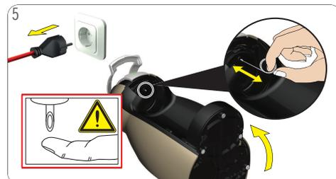
Retire el enchufe de alimentación. Retire la rejilla de goteo y la bandeja de goteo. Incline la máquina para acceder mejor al inyector. ¡No toque nunca el inyector con los dedos! Limpie el inyector con la aguja de limpieza. Siga las instrucciones de 8. «Descalcificar al menos cada 3 ó 4 meses» en la página 13.
